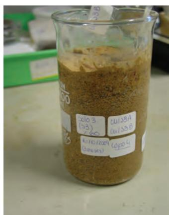
**Fig. 3** - Fotografia de um copo contendo os provetes de cobre totalmente enterrados
