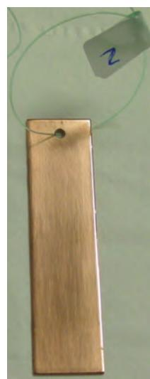
**Fig. 2** - Fotografia de um provete de cobre polido e etiquetado.
