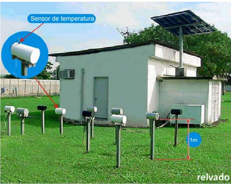
**Fig. 1** – Cilindros com e sem revestimento por pintura no pátio do Cepel (RJ).
