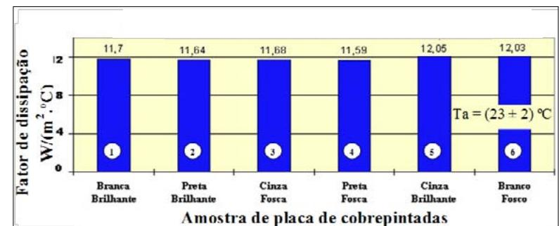
Fig. 11 – Dissipação térmica das placas de cobre pintadas.
